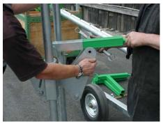
Die Verstellspindel am Rührstangenträger abstecken.
