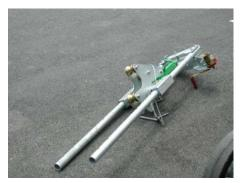
Danach das Führungsrohr mit Rührstangenträger und Seilwinde am Zweiradgestell festschrauben.
