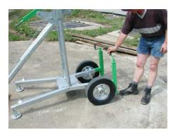
Die beiden Stützen soweit herauskurbeln, bis die Räder mit Sicherheit vom Boden abgehoben sind. Bei einem Betonboden ist es vorteilhaft, Schlitze für die Stützen einzuschleifen. Diese Stützen übernehmen gemeinsam mit den vorderen Stütztellern während des Betriebes die auftretenden Schubkräfte.
