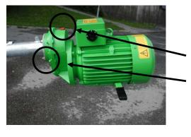
Beim MEX 450 G ist das Getriebe mit 0,3 l Öl Shell X15W/40 gefüllt. Auch hier ist ein Ölwechsel nur bei einer Reparatur vorzunehmen.
