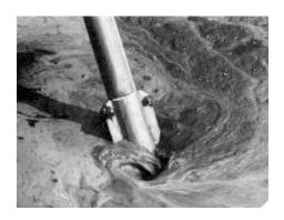
Optisch richtet man sich am besten nach der Befestigungsschelle des Schutzbügels. Sie soll gerade noch sichtbar sein. Auf diese Weise wird in gewissen Abständen etwas Luft mit eingesaugt, die den Rührvorgang noch unterstützt, dabei aber kaum Schaum bildet. Nur bei Gülle mit starkem Bodensatz (Schweinegülle, Hühnermist, Mist mit hohem Sägespäneanteil und dgl.) ist die Rührstange zum Aufrühren möglichst tief abzusenken.
