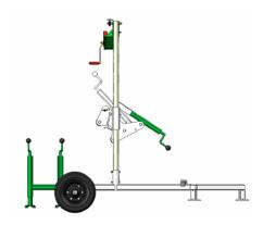
Die Verstellspindel kann auch um 180° gedreht eingebaut werden
