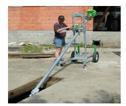
Mit der Seilwinde, zum Heben und Senken, und mit der Handhebelspindel, zum Schwenken der Rührstange, kann diese mühelos in die Grubenöffnung (mindestens 60 x 60 cm) eingeführt werden.
