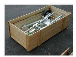
Zum leichteren Transport werden das Zweiradgestell, das vertikale Führungsrohr mit dem Rührstangenträger und der Seilwinde sowie die komplette Rührstange mit Motor, Stirnradgetriebe, Rührflügel und Schutzbügel lose geliefert und müssen vor der ersten Inbetriebnahme zusammengebaut werden.
