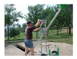
Bei einer Grube mit kleiner Öffnung muß der Rührstangenträger vorerst mit der Seilwinde in der obersten Rasterstellung beim Führungsrohr fixiert und die Rührstange selbst mit der Handhebelspindel stark geschwenkt werden.
