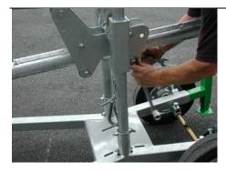
Die beiden unteren Rollen mit den Distanzhülsen beim Rührstangenträger ausbauen.....
