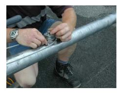
Die Seilschleife vom Rührstangenträger ausgehend über die Umlenkrolle legen...
